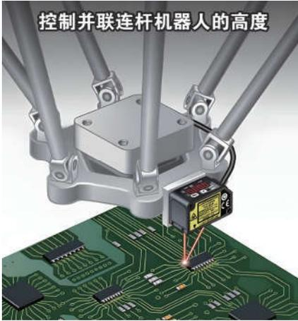
控制并联杆机器人的高度
